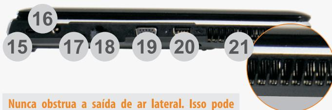
**Nunca obstrua a saída de ar lateral. Isso pode causar mal funcionamento do aparelho e redução de vida útil.**
